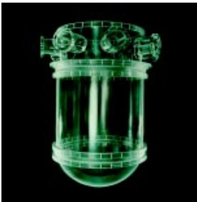
Das Reaktormodell bildet das Kernstück von ROCOM – es ist detailgetreu aus Plexiglas (1:5-Modell) gefertigt und ermöglicht auch Messungen der Strömungsgeschwindigkeit des Wassers mit optischen Methoden (Laserstrahlen).
