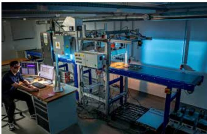
Der Highspeed-Images-Demonstrator dient der Erfassung, Identifizierung und Sortierung komplex zusammengesetzter Recyclingstoffströme. ©HZDR/Detlev Müller
