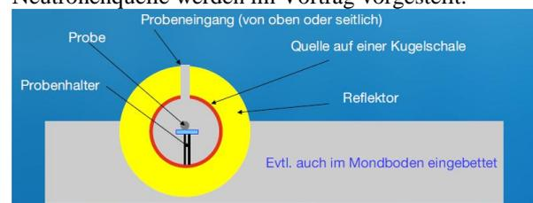
**Abb. 2:** Design der Bestrahlungseinrichtung mit Cf-Quelle des ISAGE-Projekts.
