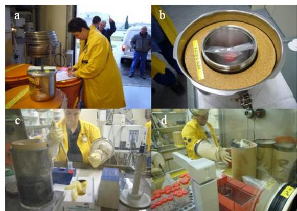
**Abb. 2:** Probenannahme im INE (a), Transportbehälter mit der Probe (b), Verdünnungsschritt in der Probenvorbereitungsbox (c), Messung in der ICP-OES-Box (d).
