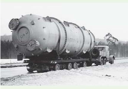
Transport des Drucktanks für den TANDEM-Generator
