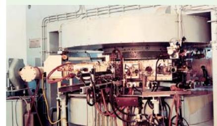
Zyklotron U-120 mit Ionenquelle
