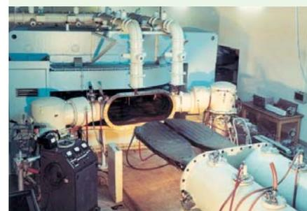
Zyklotron U-120 mit ausgefahrenem Resonanzsystem
