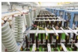
Das Hochfeld-Magnetlabor im FZD ist eines von weltweit zwei Laboren, das in der Lage ist, höchste gepulste Magnetfelder für die Materialforschung mit einer Stärke von 85 Tesla zu erzeugen. Im März setzten die Wissenschaftler einen neuen Magneten ein, der eine Feldstärke von 87,2 Tesla erzeugte - das ist einzigartig in Europa.
