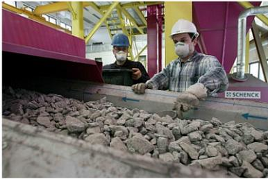
Einer der wichtigsten Prozesse bei der Gewinnung von wertvollen Metallen aus Lagerstätten ist die Aufbereitung. Hierfür wird das Gesteinsmaterial durch eine Reihe unterschiedlicher Verfahren zerkleinert und die Erze vom nichtbrauchbaren Nebengestein getrennt. Welche Verfahren dabei genau zum Einsatz kommen, hängt von den Eigenschaften der Erze ab, wie zum Beispiel von der mineralogischen Zusammensetzung oder der Konzentration der darin befindlichen Wertelemente.
