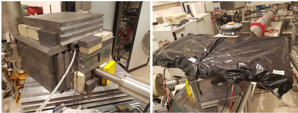
Abbildung 3.3.: Das Foto links zeigt die Bleiabschirmung des verwendeten Messaufbaus. Auf dem rechten Foto sind die oberhalb der Abschirmung platzierten Szintillatorblöcke zu sehen, die als Myonenveto verwendet wurden.
