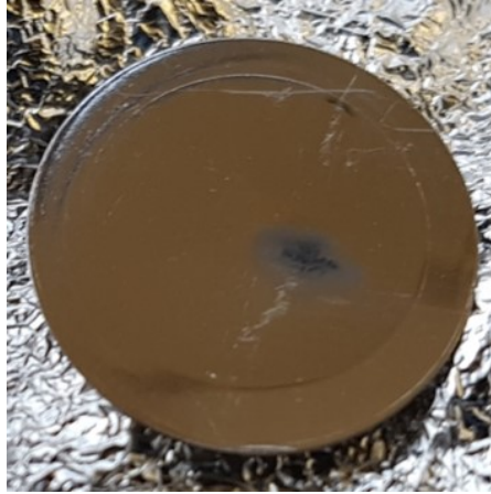
Abbildung 4.10.: Dargestellt ist die Rückseite einer bestrahlten Probe am Beispiel der Probe 6-200-hy. Der schwarze Fleck auf der Oberfläche der Rückseite ist bei allen verwendeten Proben zu sehen und entspricht der Position des Strahlflecks auf der Vorderseite.
