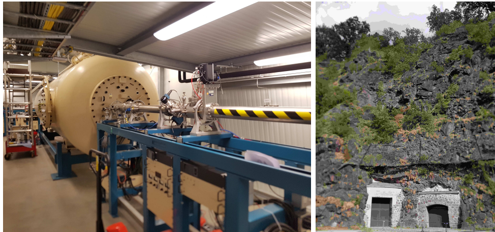
Abbildung 7.1.: Auf dem linken Foto ist der Pelletron-Tank und Teil des äußeren Beschleuniger-Strahlrohrs im Felsenkeller-Labor zu sehen. Auf dem Foto rechts ist der Stollen von außen mit den beiden Eingängen zum Labor abgebildet.
