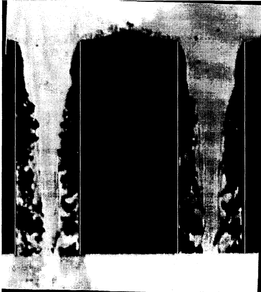
Bild 5: Abspritzung mit p_e = 100 bar gegen Atmosphärendruck. T = 295 K, Fluid: Decalin, von oben nach unten strömend. \Delta t = 680 ns. Die zusätzlich eingezeichneten weißen Linien verdeutlichen die Breite des Düsenkanals.
