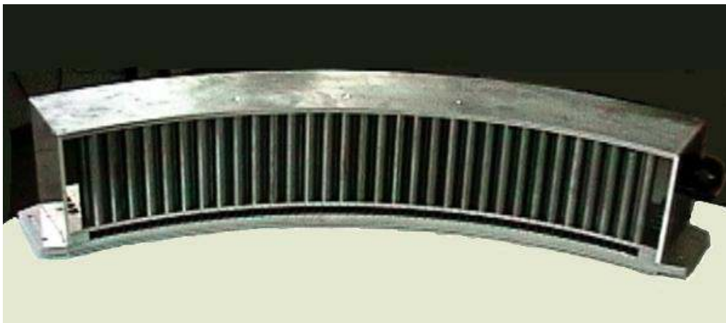
Bild 3.7: Gehäuse des Detektorbogens im Rohbau, die senkrechten Röhren beinhalten die Photomultiplier, der darunterliegende waagerechte Schlitz nimmt die Detektorkristalle auf.
