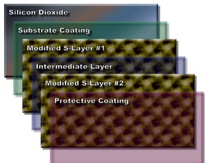
Abbildung 27: Schematische Darstellung eines mehrschichtigen Systems mit funktionellen und Zwischenschichten
