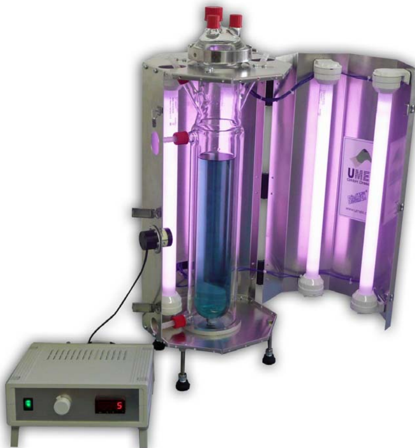
Abbildung 46: Universeller Labor-Reaktor für die Photobiotechnologie
