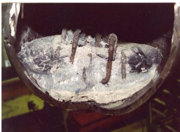
Bild 2-4: Nach dem Experiment aufgeschnittener Behälter
