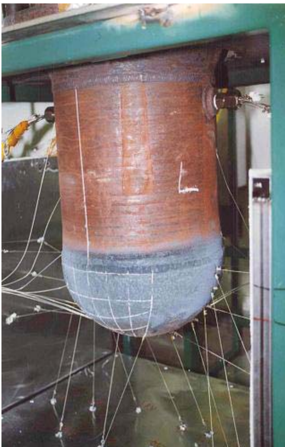
Bild 2-2: FOREVER-Behälter mit Verschiebungssensoren
