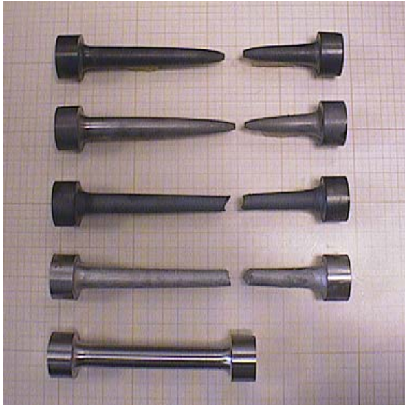
Bild 6-17: Proben aus LHF-Material von Kriechversuchen bei verschiedenen Nominalspannungen bei 720 °C (Nr. 1 u. 2 von oben) und 990 °C (Nr. 3 und 4 von oben); [Mongabure 2000]
