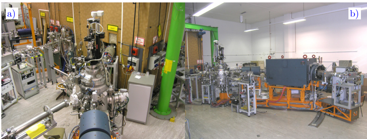
Abbildung 2.2: Fotografie a) der Streukammer b) des QQDS Magnetspektrometers (orange farben: Lafette)
