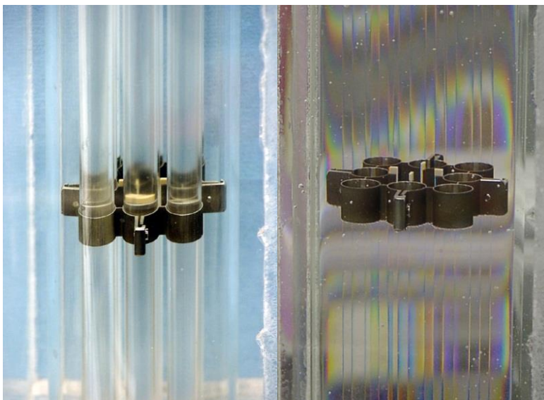
Abb. 5: Stabbündel mit Abstandshalter, links ungefüllter, rechts: mit P-Cymol gefüllter Zustand
