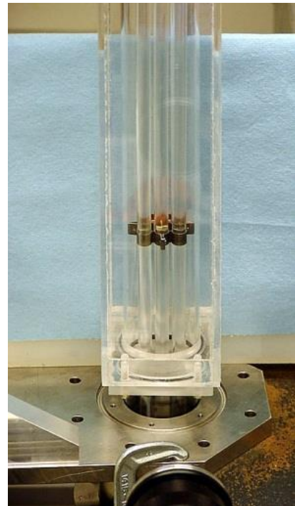
Abb. 4 PMMA-Stäbe und -Hüllrohr, von PMMA-Container umschlossen, ungefüllter Zustand
