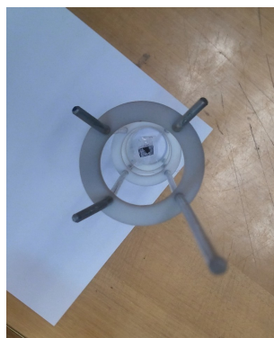
(b) Ansicht des Targethalters in Strahlrichtung mit eingespanntem ^{77}\text{Se} Target
