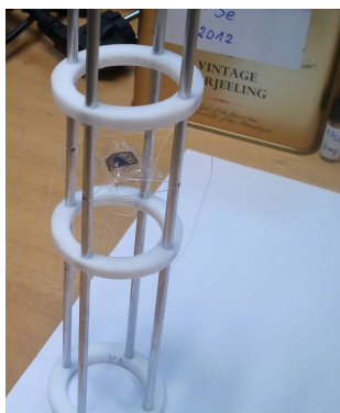
(a) Seitliche Ansicht des Targethalters mit eingespanntem ^{77}\text{Se} Target
