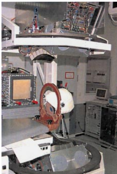
Abb. 7 Positionierung eines Kopfphantoms zur Bestrahlung dessen rechter Seite am Bestrahlungsplatz bei der GSI Darmstadt.
