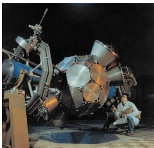
Abb. 2 Aufnahme von Montagearbeiten am FOBOS-Detektor. Erst zwei der insgesamt 30 konusförmigen Module sind in die zentrale Reaktionskammer eingesetzt. Foto: Yu. Tumanov, VIK
