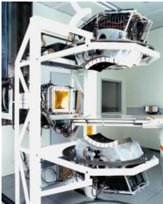
Abb. 6 Der medizinische Bestrahlungsplatz bei der GSI Darmstadt mit integrierter Positronenkamera. Der horizontale Therapiestahl kommt von links hinten. Oberhalb und unterhalb der Patientennliege sind die positionsempfindlichen Detektoren für die Annihilationsstrahlung montiert (Foto: A. Zschau, GSI Darmstadt).
