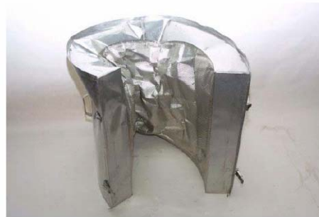
Deformierte aber geschlossene Kasette nach Versuch
