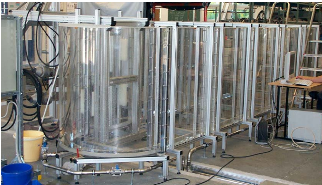
Bild 7: Zittauer Ringkanal zur Untersuchung der Suspension und Sedimentation von Mineralwollpartikeln in der Sumpfstromung.
