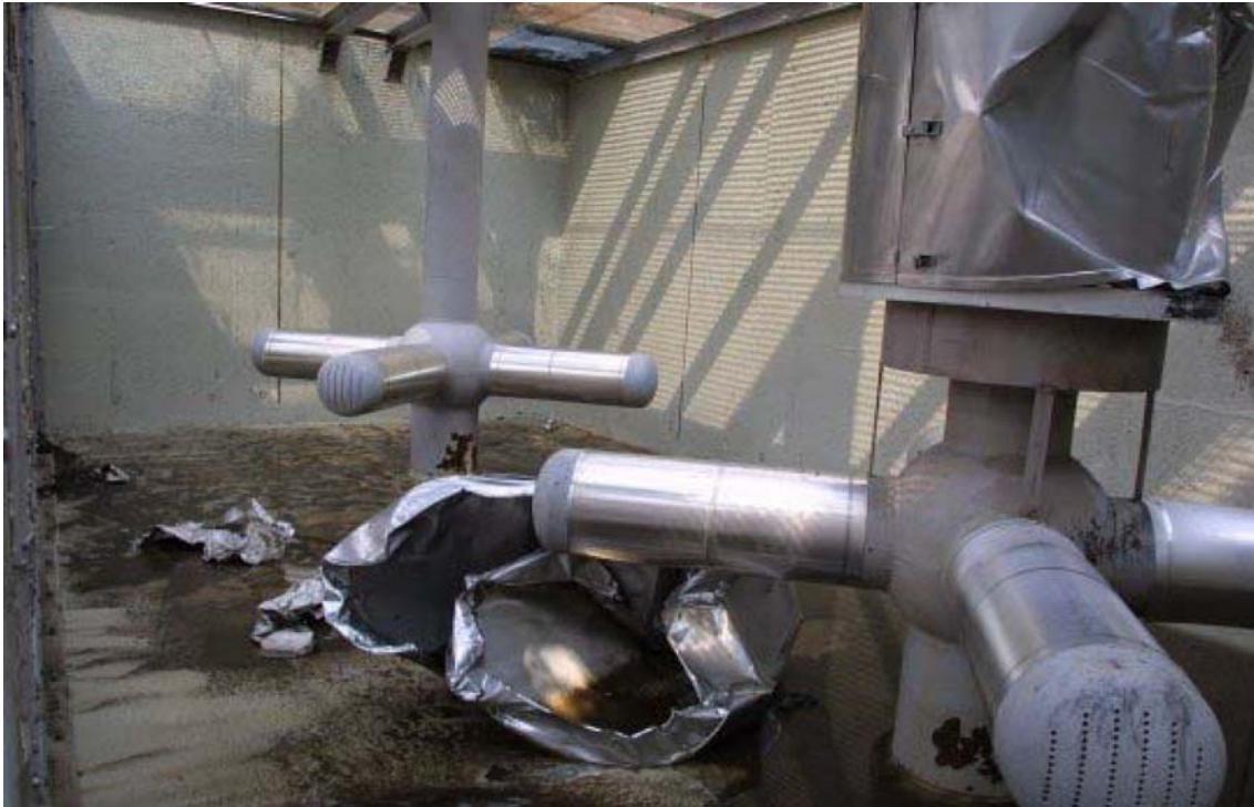
Bild 5: Versuche der AREVA NP zur Freisetzung und Fragmentierung von Isolationsmaterial.
