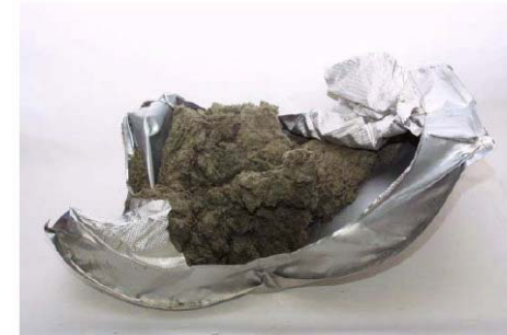
Kasette nach Versuch mit Restinventar an Mineralwolle
