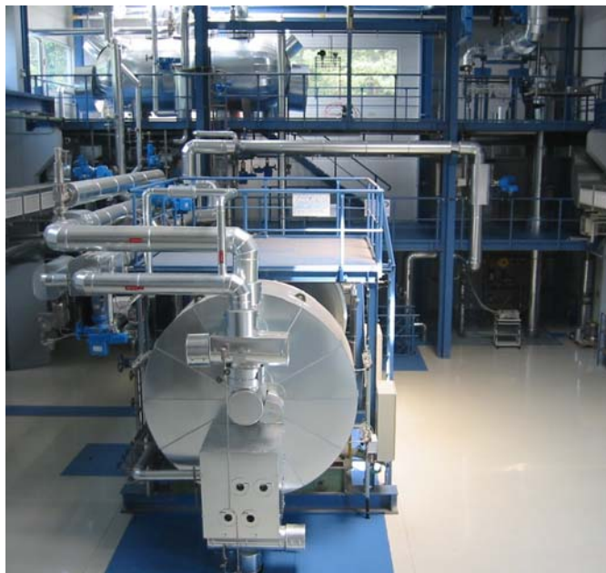
Bild 6: Transient Two-Phase Flow Test Facility (TOPFLOW) für Experimente zu transienten Zweiphasenströmungen bei reaktortypischen Parametern.
