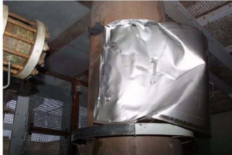
Zusammengedrückte aber geschlossene Kasette nach Versuch
