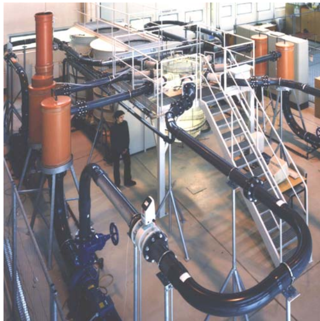
Bild 3: Rossendorf Coolant Mixing Test Facility (ROCOM) zur Untersuchung der Kühlmittelvermischung in DWR.
