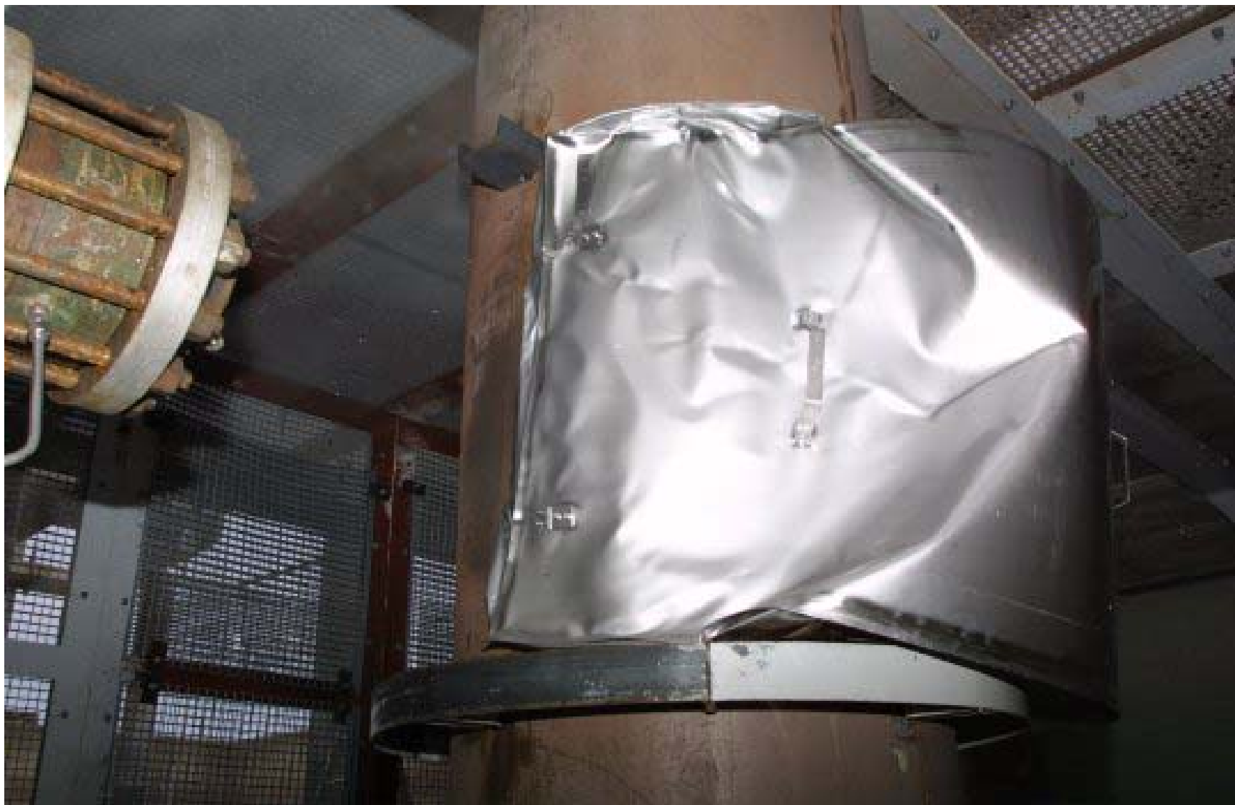
Zusammengedrückte, aber geschlossene Kasette nach Versuch FV5_1
